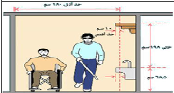
شكل رقم ٥ - قطاع رأسي توضيحي لممر بوضوح الأبعاد الأفقية والرأسية المشترط التصميم على أساسها داخل دورات المياه في المنشآت التعليمية. المصدر (٨)
