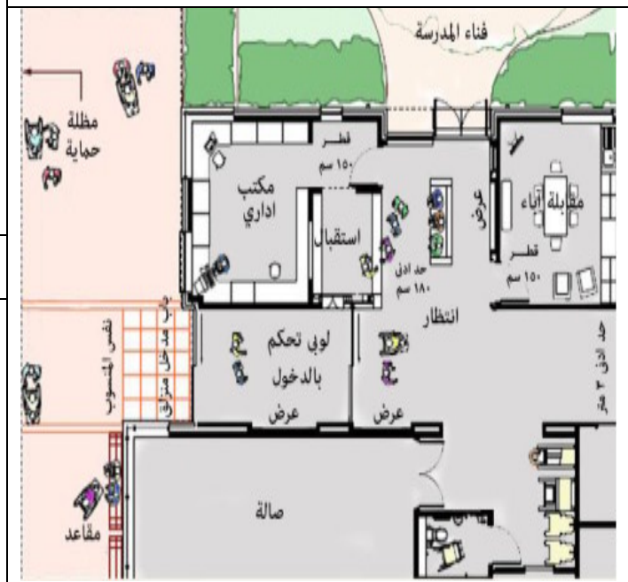
شكل رقم ٣ - مسقط أفقي لأحدى المدارس المقترح بنائها بمدينة تبوك - السعودية ويبين مدى سهولة الحركة المدخل الفراغات فيما حوله. المصدر: (١٠)
