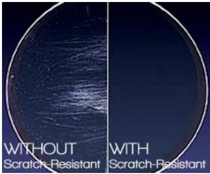
شكل (١٥): يوضح تقنية ضد الخدش ومقاومة للتآكل لمواد النانو المصدر:
