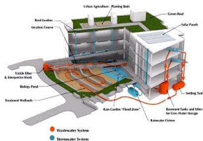
شكل رقم ٧ - دراسة العلاقات بين الانظمة المختلفة داخل المبنى (الطاقة الشمسية، ادارة المياه، ادارة النفايات، انظمة التبريد) - المصدر http://www.solaripedia.com/13/304/3452/sidwell_friends_wetlands_diagram.html
