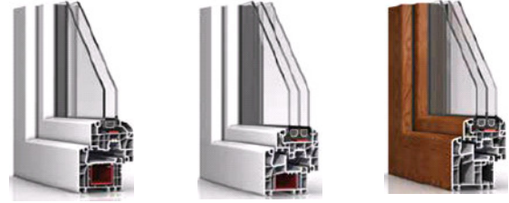
شكل رقم ٩- يوضح استخدام الإطارات المحكمة و الفواصل الهوائية بين ألواح الزجاج لعزل الحرارة بالشبابيك (العمارة والتحكم البيئي، ٢٠١٨) ٢٠
