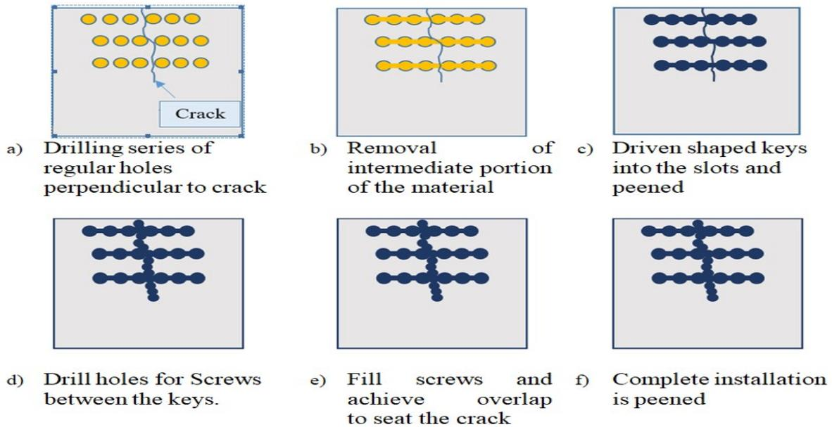
Fig. 8. Fatigue Repair
